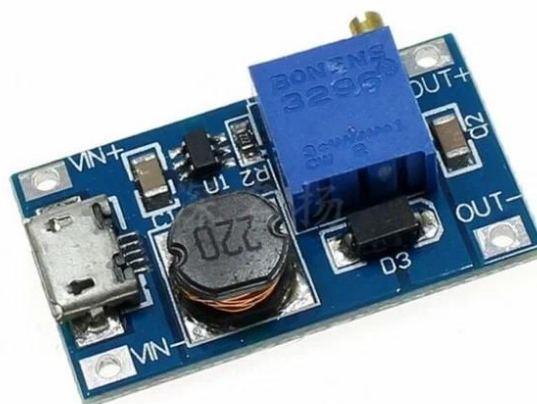
Рисунок 3.4 – DC-DC преобразователь MT-3608
