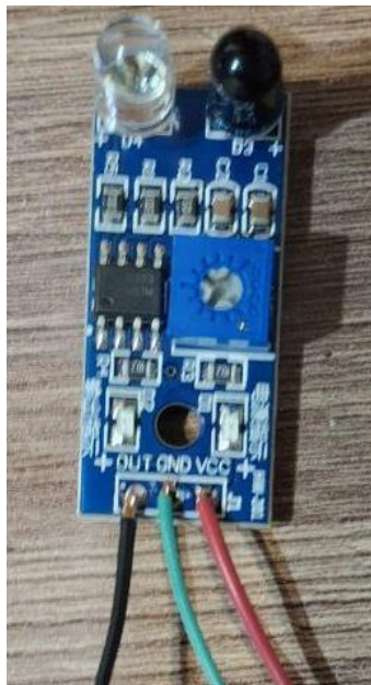
Рисунок 4.7 – ИК-датчик HW-201 (YL-63)
