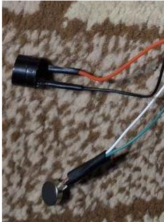
Рисунок 4.9 – Подготовленные Модули Buzzer (пищалка) и вибромотор «Таблетка»
