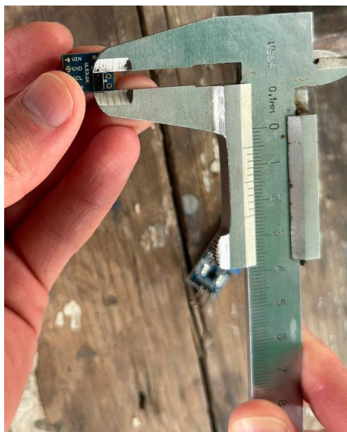
Рисунок 4.2 – Замер лазерного датчика с использованием штангенциркуля
