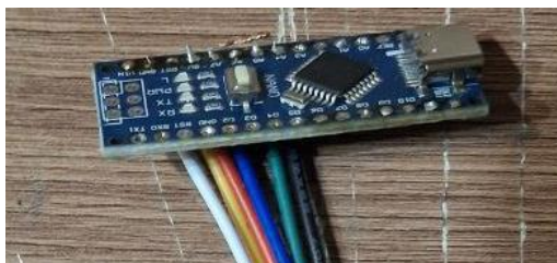
Рисунок 4.6 – Подготовленная плата микроконтроллера Arduino Nano
