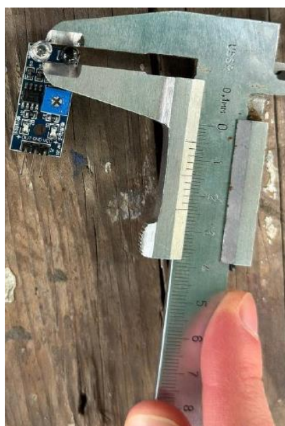
Рисунок 4.3 – Замер ИК-датчика с использованием штангенциркуля
