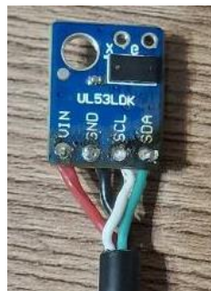
Рисунок 4.8 – Лазерный датчик VL53L0X GY-530
