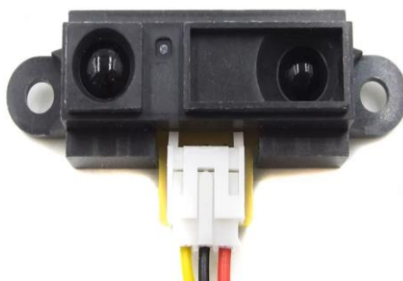
Рисунок 1.2 - Оптический аналоговый датчик Sharp GP2Y0A21YK0F
